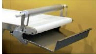
Sus dimensiones son muy reducidas cuando la máquina está en posición de reposo. Esto es posible gracias a su sistema de alzamiento de las mesas que permite facilitar trabajos de limpieza y un mejor almacenaje hasta su próxima utilización. De este modo queda libre un gran espacio útil para otros trabajos.
