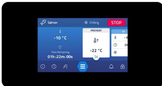
**Display 4.3'** con pantalla capacitiva en color. Equipado con señal acústica con intensidad regulable y tono fijo. El operador tiene la posibilidad de personalizar y/o crear nuevos ciclos que se recogen en la librería.
